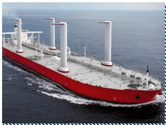
L'aile est montée sur une embase structurelle qui contient le ventilateur d'aspiration nécessaire au fonctionnement du système. Ce système produit une force qui propulse le navire en combinaison avec le moteur principal.
